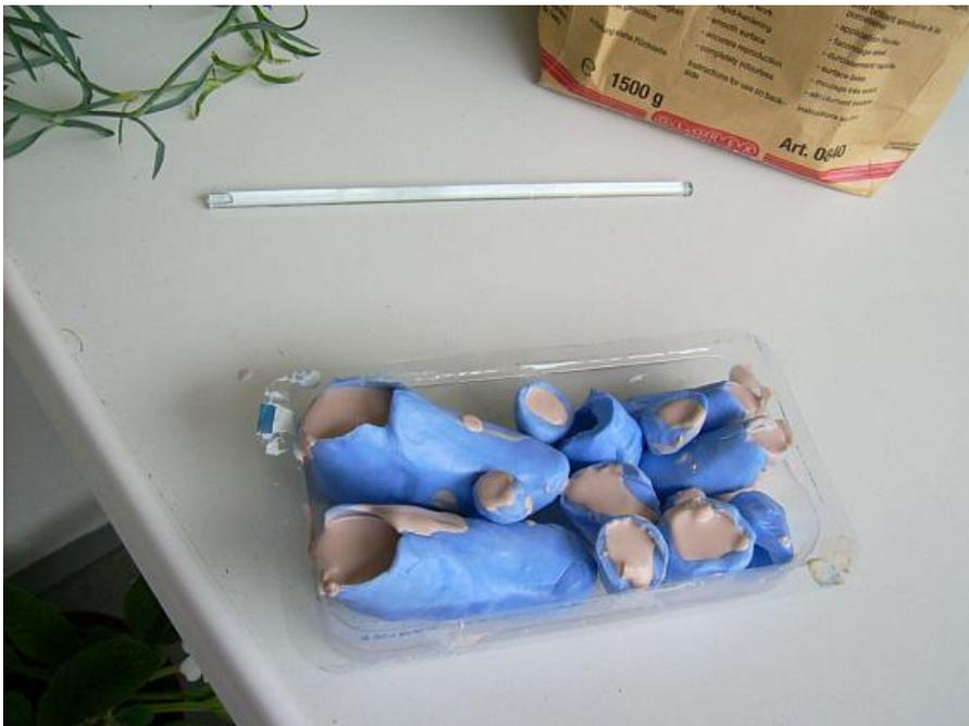
Nun mußt Du Deine Fuß- und Absatzformen mit der Gießmasse füllen und ca. 90 Minuten trocknen lassen. Dann kannst Du Deine Modelle herauslösen. Sei nicht geschockt, sie müssen mit Sandpapier noch kräftig bearbeitet werden.
